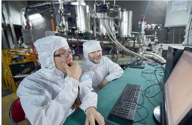
在地处四川南部地底 2400 米的中国锦屏地下实验室，PandaX 实验组的研究人员对设备进行维护。该实验组利用在空气中提纯的惰性元素氙作为探测媒介来寻找暗物质。
